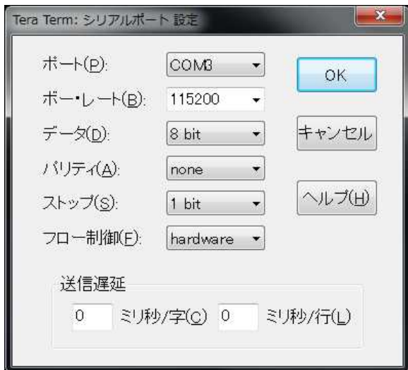
図 3 - 1 1 : Tera Term のシリアル通信設定
