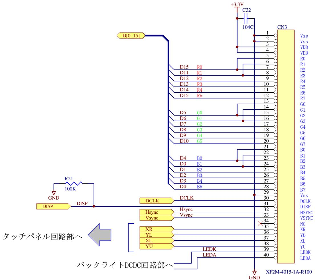
上図は、KS-430CT-I2 に DENSITRON 社製 LMTM043WQVNCB-4R を接続する場合の参考回路図です。
