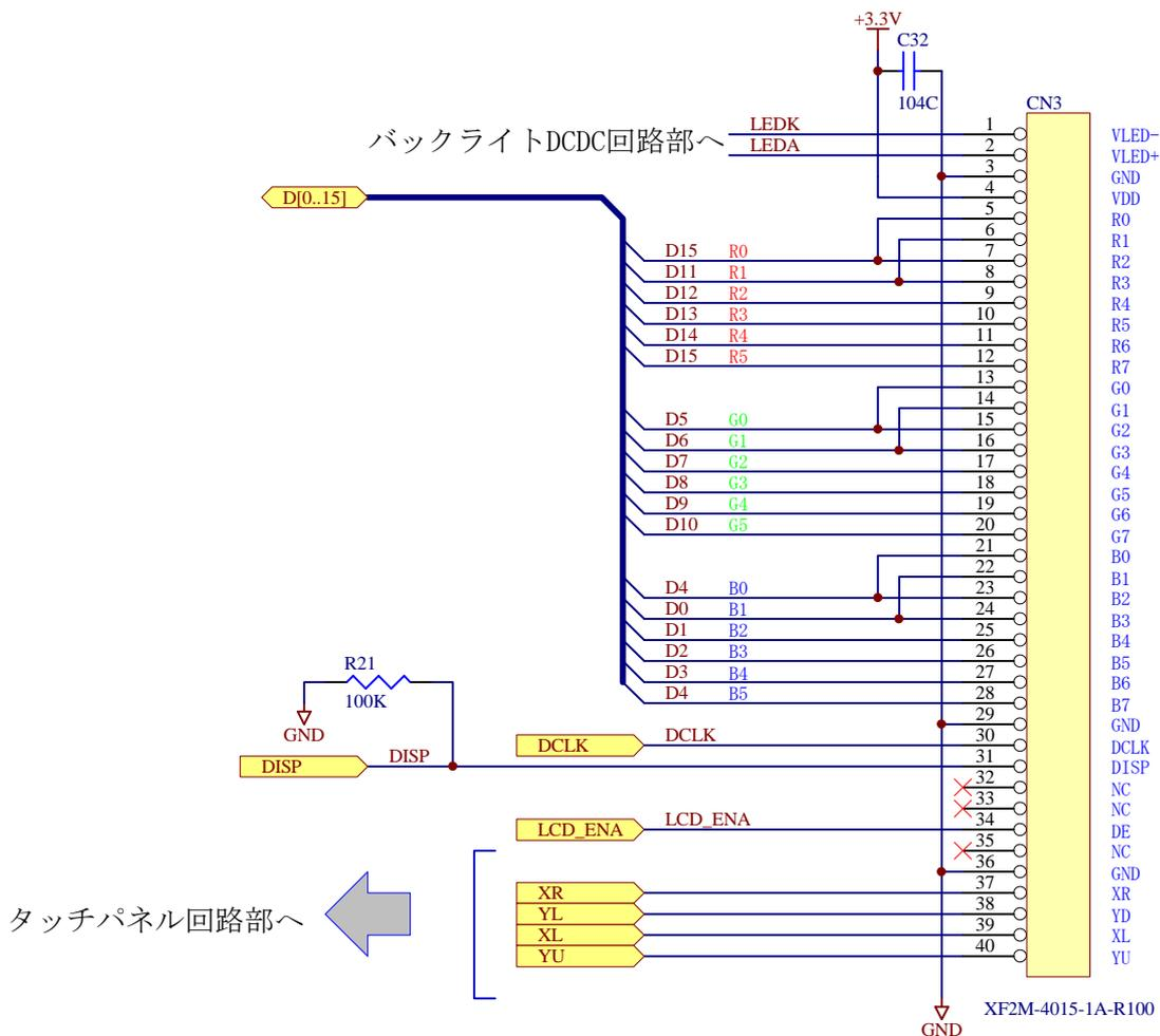
上図は、KS-430CT-I2 に Zettler 社製 ATM0430D12-T 又は RAYSTAR 社製 RFE430G-AIW-DNS 又は RAYSTAR 社製 RFE43AU-AIW-DNS を接続する場合の参考回路図です。
