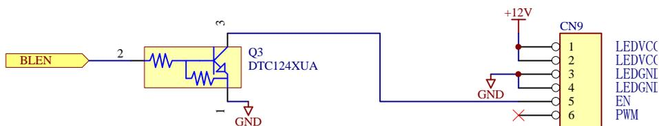
図 2 バックライト I/F 参考回路
